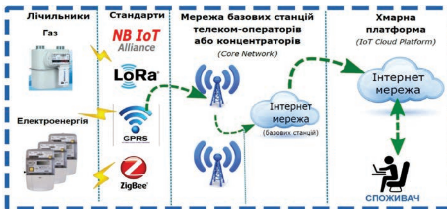
Рис. 1. Типова функціональна блок-схема розвинутої вимірювальної інфраструктури (АМІ) обліку енергоресурсів на основі ІСО-системи передавання даних телеметрії від газових лічильників
